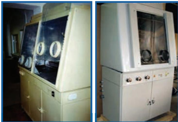
Радиохимические вытяжные шкафы ШВ-1РМ и ШВ-2РА производятся по ТУ 95 2748-2000, соответствует требованиям ГОСТ 23308-78 «Шкафы вытяжные радиохимические. Общие технические требования» (внутренний радиус гибких углов рабочей камеры 20 мм), а также требованиям ГОСТ 25743-83 «Шкафы вытяжные радиохимические. Типы, основные параметры и размеры».
